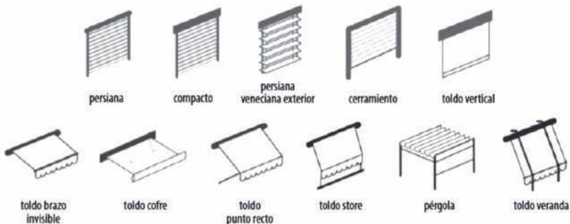
Figura 13. Ejemplos de sistemas de protección solar [12]
