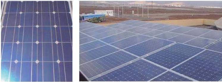
Figura 23. Panel fotovoltaico monocristalino y planta fotovoltaica instalada en cubierta.
